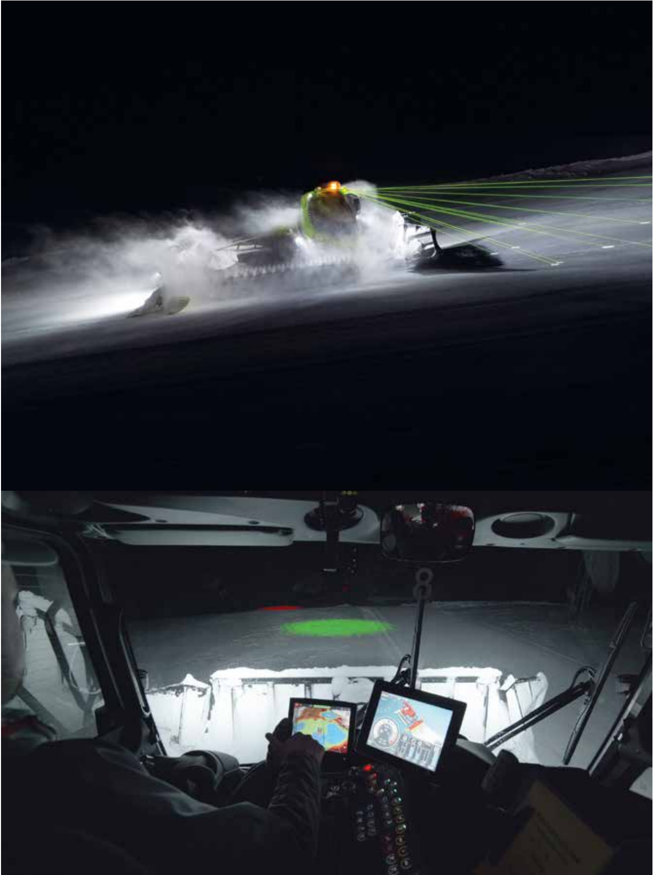
OBEN: Das SNOWsat-System misst mit der GPS Technologie die Schneehöhe im Skigebiet UNTEN: Das SNOWsat- System im Einsatz bei den Pistengeräten der Katschbergbahnen
